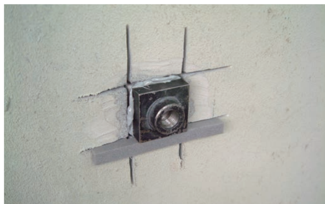
施工例：引張試験機のアタッチメントの接着材用途
