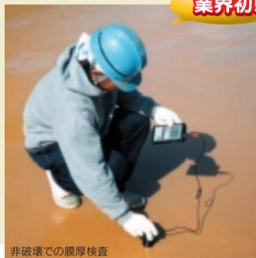
非破壊での膜厚検査
