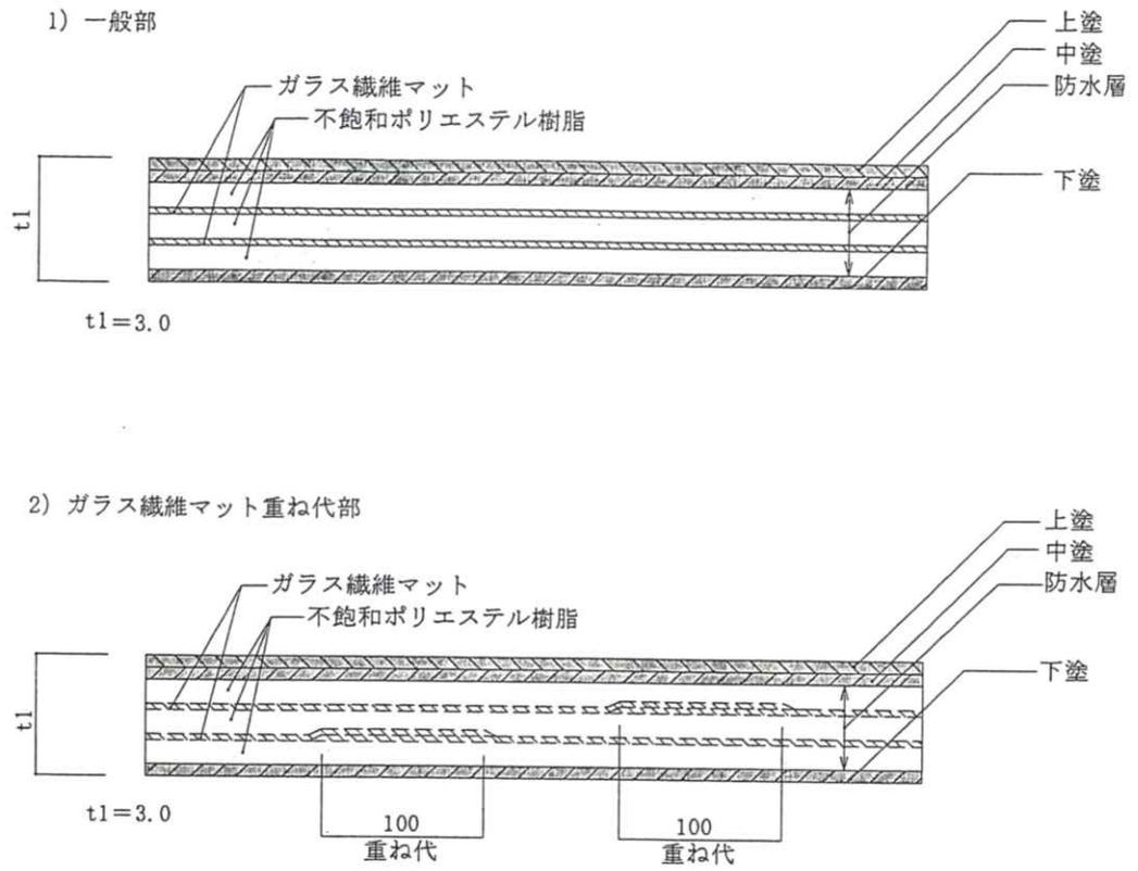
図1 FRP防水材の断面図
