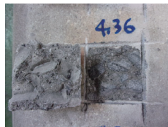
コンクリート破壊状況
