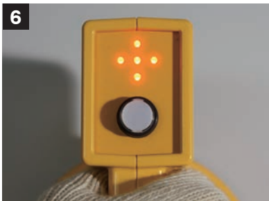
IWディスクのセンターを検知後、全てのライトが点灯し、自動で加熱開始(同時にシート表面温度を測定し加熱秒数を自動で決定)
