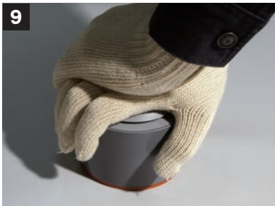
専用圧着治具で約8秒押える
