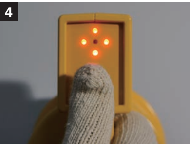
加熱作業前に、IWディスクから離れた場所で位置検知スタートボタンを押す(約1秒)
